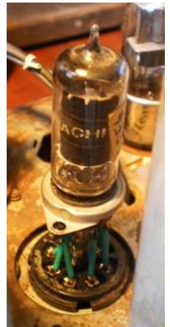
À esquerda o esquema original das válvulas e à direita a válvula exótica 6BE6, ligada com uma adaptação por fios à base da original 6SA7.
