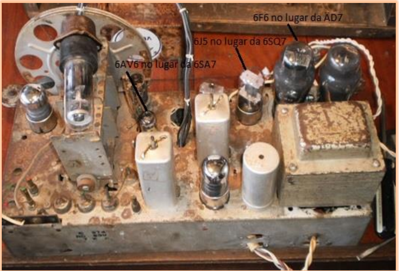
O chassi como foi recebido com as válvulas não originais.
